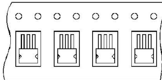
编带器件定位/UNIT ORIENTATION
