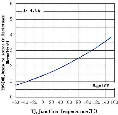
图 3 归一化导通电阻与温度曲线
