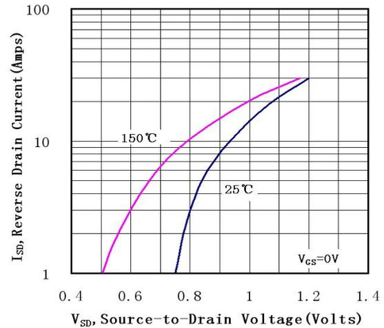
图 4 二极管正向电压曲线
