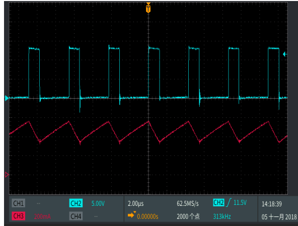
SW 脚与电感电流工作波形
