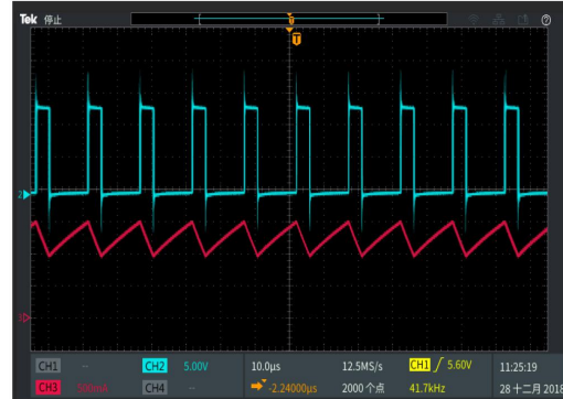
SW 脚与电感电流工作波形
